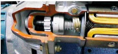
Figura 20.- Mecanismo de conexión por efecto de inercia.
